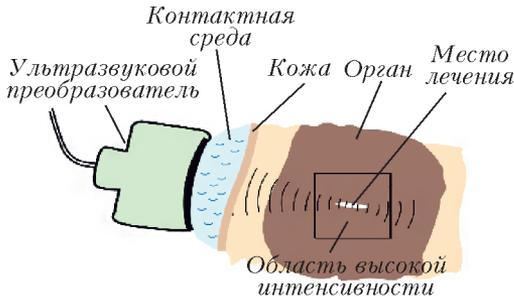
Рис. 5. Схема ультразвукового воздействия на биологические ткани. Пучок интенсивного фокусированного ультразвука используется для локализованного разрушения опухоли или остановки внутреннего кровотечения без повреждения окружающей ткани. Акустическая энергия, излучаемая ультразвуковым преобразователем, концентрируется в объем, примерно равный объему рисового зерна
