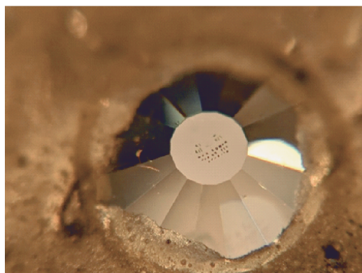
Рис. 3. Алмазная наковальня под микроскопом — калетта бриллианта диаметром 0,5 мм с кристалликами, предназначенными для изучения под давлением
