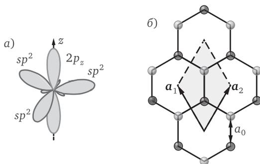
Рис. 11.1. а) Три  $sp^2$ -гибридизованные орбитали атома углерода и перпендикулярная им  $2p_z$ -орбиталь; б) кристаллическая гексагональная решетка графена как совокупность двух треугольных подрешеток А и В. Серым выделена элементарная ячейка,  $a_1$  и  $a_2$  — векторы трансляций
